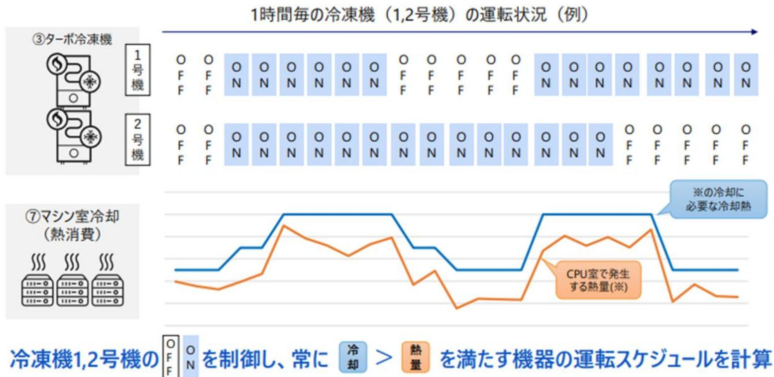
※ 熱需要増(2021年実績+30%)を考慮して、現状の1台→2台運用に変更し、最適化にて出力を適切に動作させることで、春・秋等の極端な気温になりにくい時期において、**将来的に電力消費を10%程度削減可能**なことを確認。
