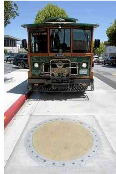
地中に設置された1次コイル 2次コイルの設置状況
