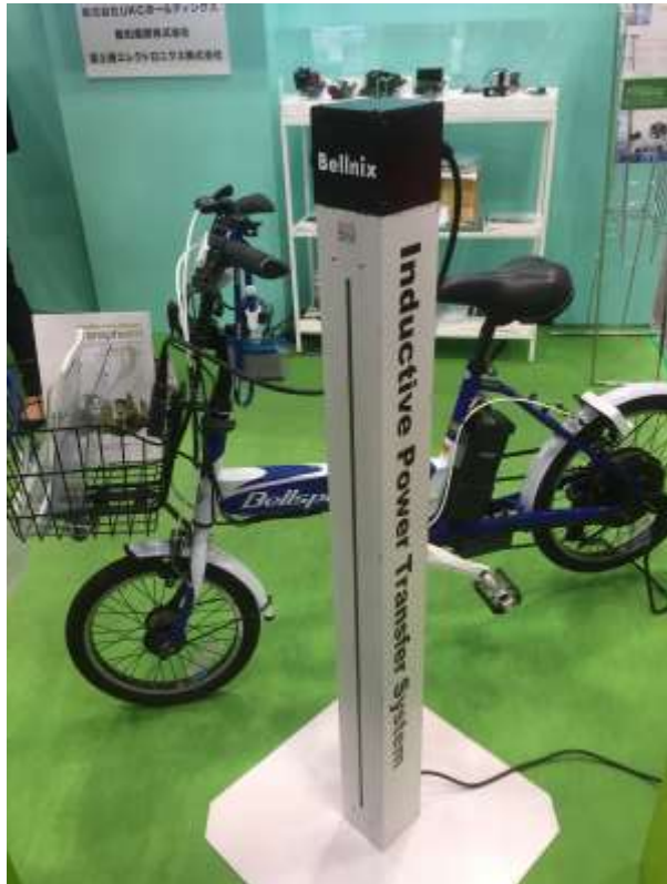
充電ポール（黒色部が送電電源）と電動アシスト自転車
