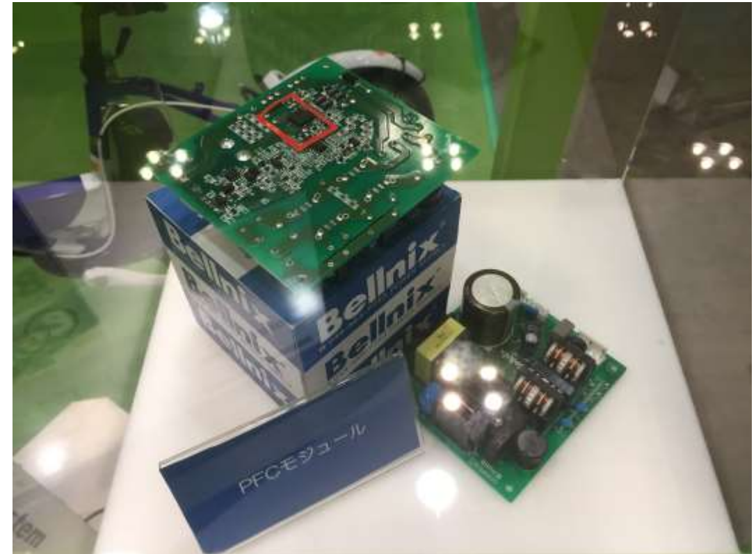
PFCユニット、赤枠で囲まれたところにGaNが使われている
