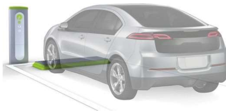
Plugless Power社 電気自動車への給電(2010年)
