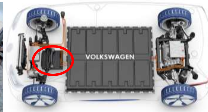
EV向けの新プラットフォーム 赤枠内が受電コイル
