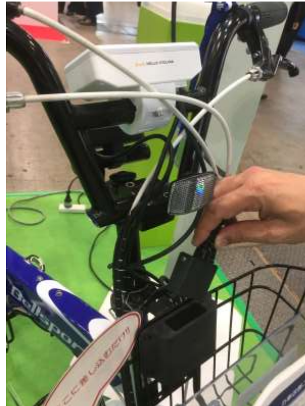
1次コイルに2次コイルを挿抜する様子
