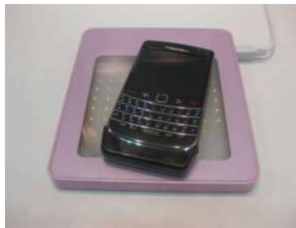
村田製作所の5W透明電極型 (WTP2012)
